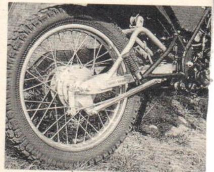
**Kawasaki AE 80:** Uni-trak-Hinterradfederung, Sechsganggetriebe, aber lahmer Motor
