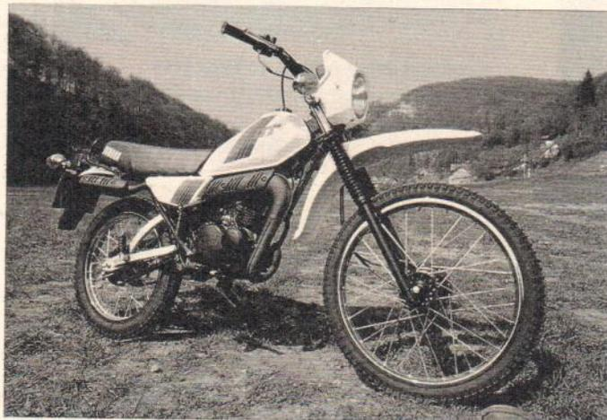
**Yamaha DT 80:** Cantilever-schwinge, Federbein nicht vorspannbar, Fußrasten an der Schwinge
