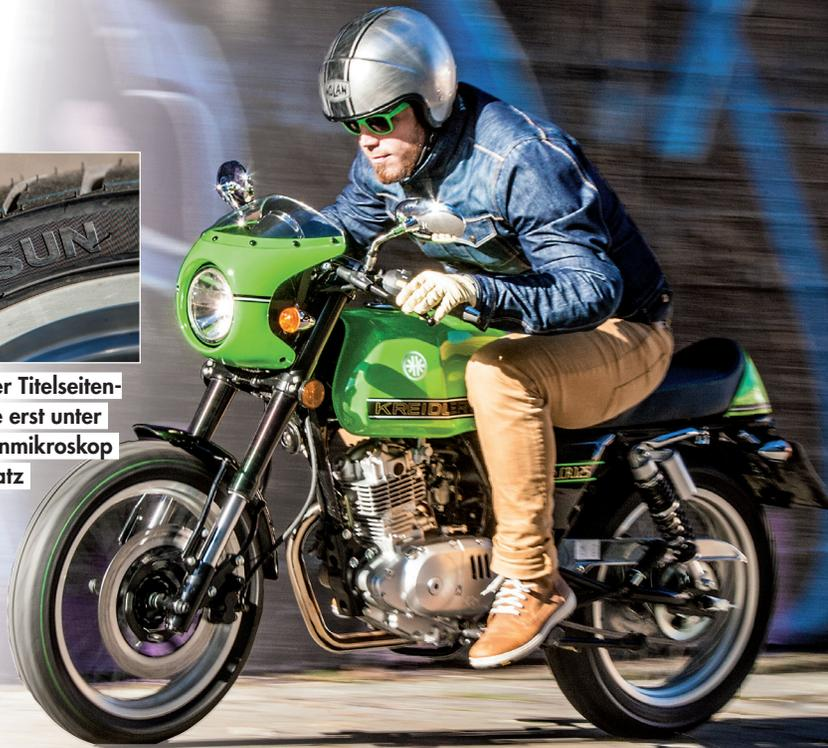
Die Bremse ist mit maximal gutmütig gut beschrieben. Selbst mit Zimmermannshänden wird man die Zweikolbenzange vorne kaum zum Blockieren nötigen. Die Bremswirkung ist nicht auf dem Niveau der edleren Konkurrenz und kommt zudem ohne ein ABS daher. Insgesamt werkelt das System aber wacker und bremst auch nach mehreren harten Manövern immer noch zuverlässig.
