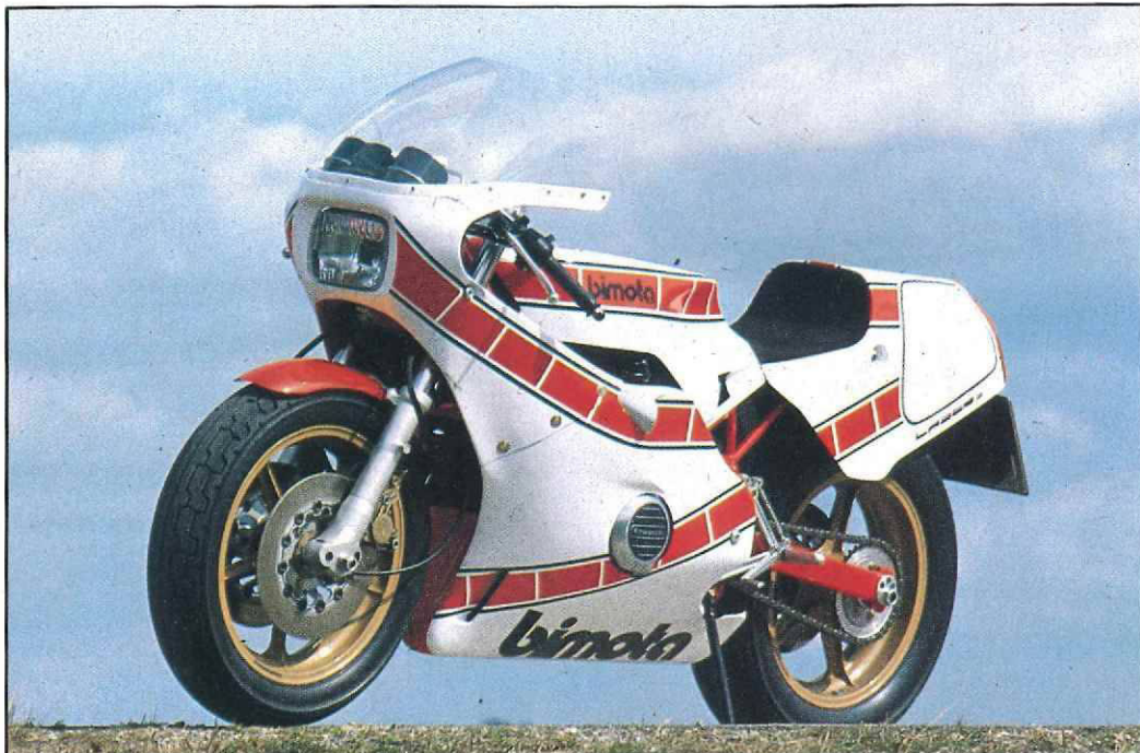
Aerodynamisch gut: Rennverkleidung unten geschlossen, Michelin-Niederquerschnittsreifen
