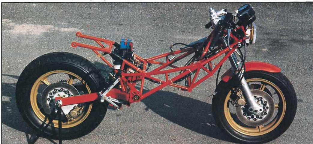
Gitterrohrrahmen: umschließt Gabel und Lenkkopf, Ceriani-Gabel mit verstellbarer Dämpfung
