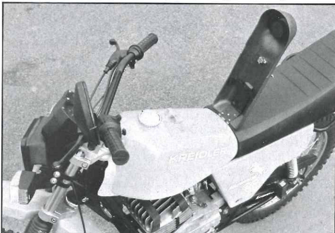
Werkzeug-, Tank- und Helmsicherung: Deckel mit Schloß
