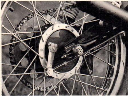
◁ Neigt zum Stempeln: Grimeca-Hinterrad-Bremse, direkt am Schwingenende verankert
