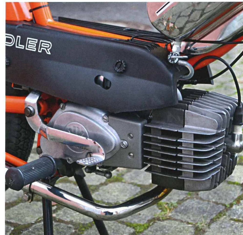
Der Exportmotor mit nikasilbeschichteter Zylinderlaufbahn
