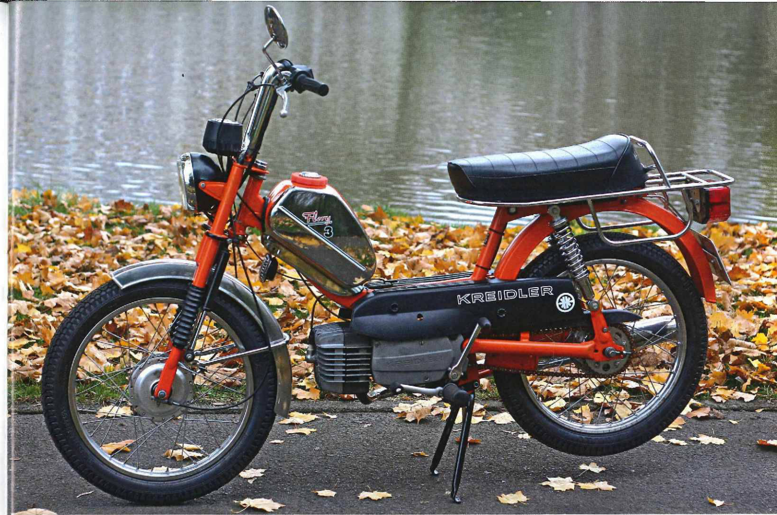
Änderungen zur deutschen Version: Vergaser, Zylinder, Auspuff, Motorritzel und Kettenrad. Ergeben laut Behördenmessung 2,2 PS bei 5500/min
