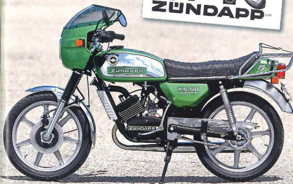
Den äußerst soliden Gepäckträger bringt die KS 50 ebenso serienmäßig mit wie die dreifach verstellbaren Federbeine
