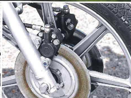
Ein Highlight bei den 50ern – die Doppelscheibenbremse sieht nicht nur wichtig aus, sie verzögert auch prima
