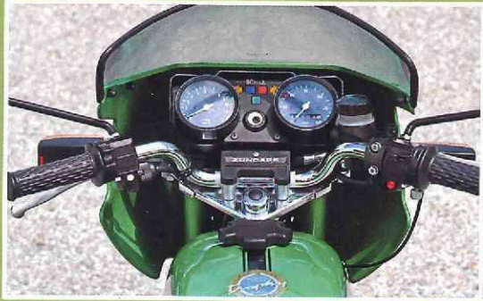
Das eigens für Zündapp gefertigte VDO-Cockpit überzeugt mit klaren Anzeigen, Kontrolllampen und modernem Design
