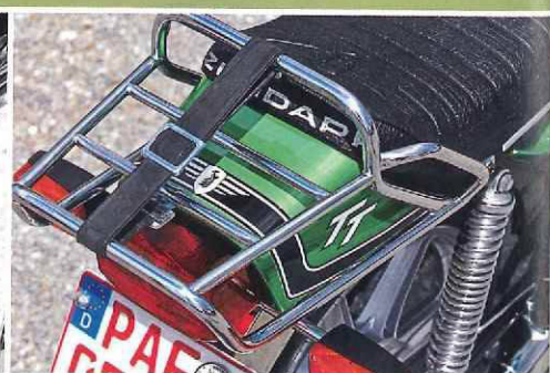
Den äußerst soliden Gepäckträger bringt die KS 50 ebenso serienmäßig mit wie die dreifach verstellbaren Federbeine
