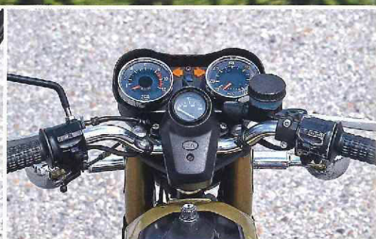
Angenehme Lenkergestaltung und Kühlwassertemperaturanzeige punkten, wild zappelnde Zeiger der VDO-Uhren nerven
