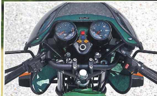
Breiter M-Lenker, hohe, schick gestylte lenker-feste Verkleidung, aber schmucklose Plastik-Wippschalter an den Lenkerarmaturen
