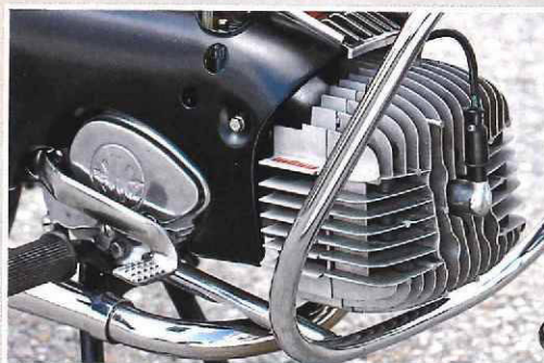
Luftgekühlt, aber beileibe keine Luftpumpe: Der bewährte Kreidler-Motor rangiert leistungsmäßig mit an der Spitze
