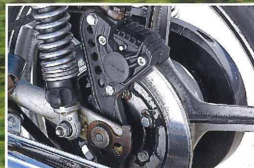
Pralle Ausstattung: Federbeine dreifach verstellbar, Brembo-Scheibenbremse auch hinten, voll gekapselte Kette – löblich
