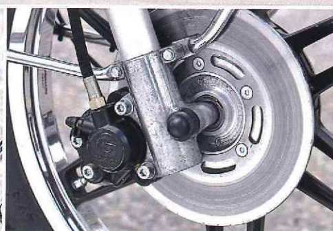
Kleine Scheibe, große Wirkung: Die Leistung der Tokico-Bremse kann sich sehen lassen. Die Verbundräder auch...
