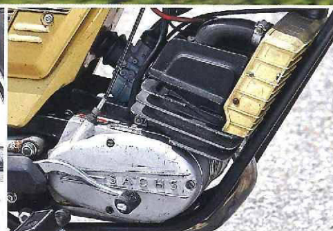
Der altbekannte, wassergekühlte Sachs-Motor wirkt in der KTM noch etwas kräftiger als in der Hercules
