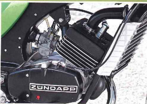
Der bildschöne Zündapp-50er ist etwas langhubiger als die Konkurrenz und kommt ohne Wasserpumpe aus
