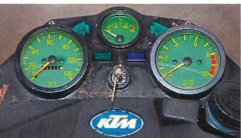
Der vielfach verwendete und bewährte Sachs-Motor tritt in der KTM besonders drehfreudig auf. Das unter einer Klappe verborgene, in den Tank integrierte Staufach bietet Platz für Klein-Utensilien oder notfalls den Regenüberzieher. Im zeitgenössischen, bei Hercules und KTM üblichen VDO-Cockpit prangt hier neben Tacho und Drehzahlmesser auch eine Kühlwassertemperatur-Anzeige
