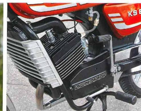
Der komplett neu entwickelte 80er-Motor musste viele Tausend harte Erprobungskilometer absolvieren. Das Resultat: ein zuverlässiger, kräftiger und ausgereifter Motor. Der gut dosierbaren und wirksamen Trommel hinten gebührt Lob, wie auch dem vollständigen Cockpit und den gut bedienbaren Schaltern
