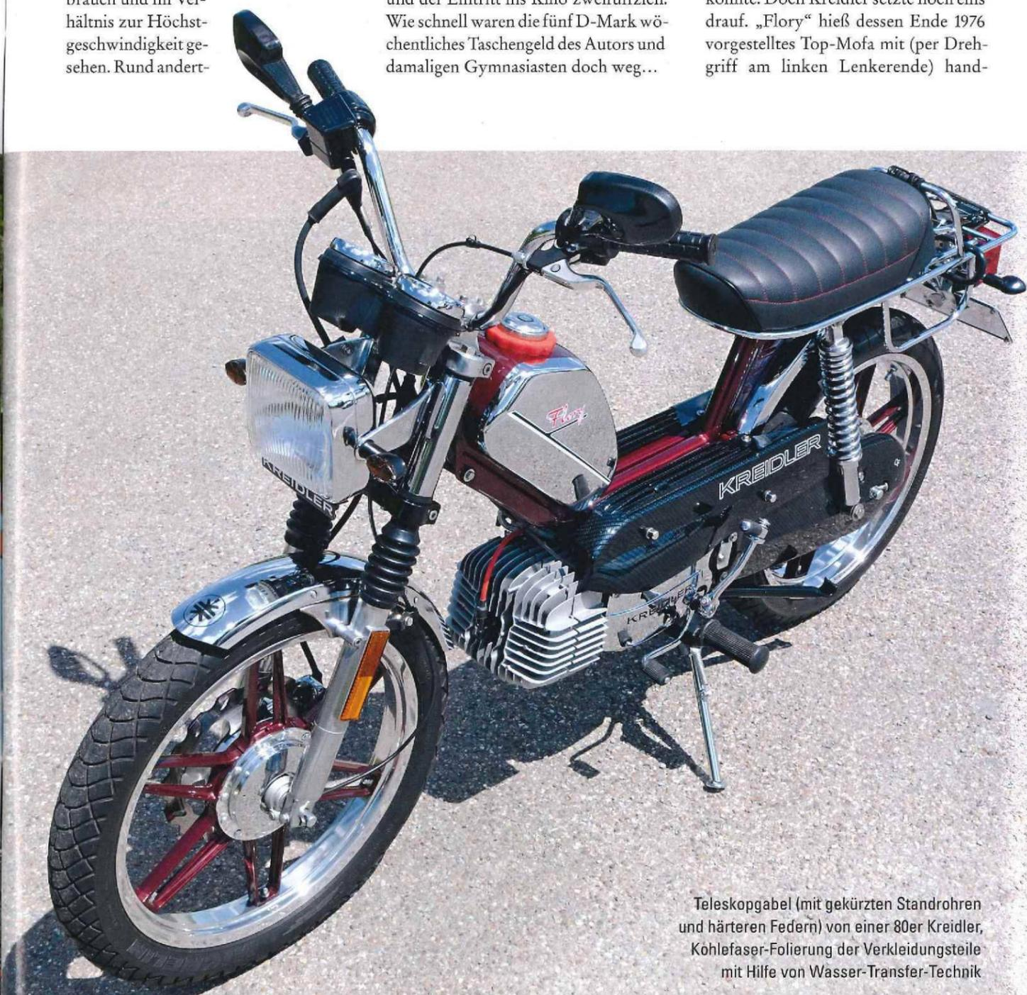
Teleskopgabel (mit gekürzten Standrohren und härteren Federn) von einer 80er Kreidler, Kohlefaser-Folierung der Verkleidungsteile mit Hilfe von Wasser-Transfer-Technik
