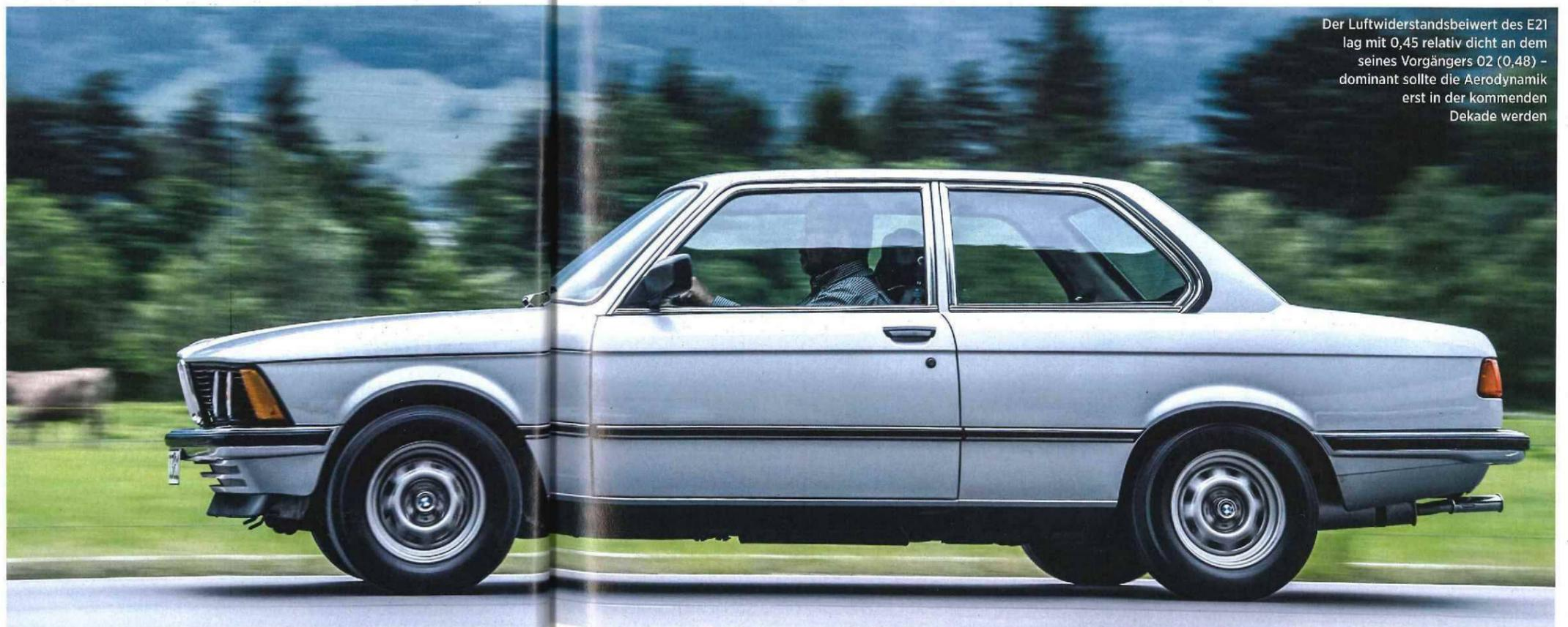
Der Luftwiderstandsbeiwert des E21 lag mit 0,45 relativ dicht an dem seines Vorgängers 02 (0,48) – dominant sollte die Aerodynamik erst in der kommenden Dekade werden
