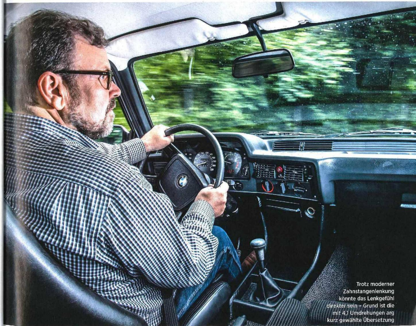
Trotz moderner Zahnstangenlenkung könnte das Lenkgefühl direkter sein – Grund ist die mit 4,1 Umdrehungen arg kurz gewählte Übersetzung
