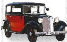
Mit Rohrrahmen, sechs Zylindern – und erstmals mit Doppelniere: BMW 303 von 1933
