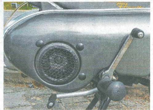
Ein typisches Merkmal der Floretts aus dem Hause Kreidler war die Gebläsekühlung mit der Ummantelung des Zylinders.
