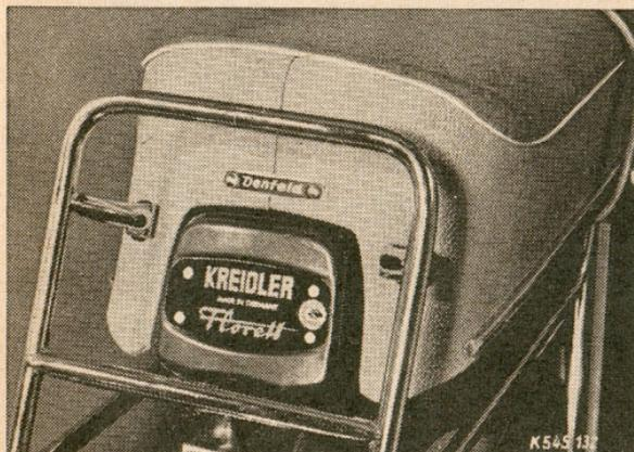
liegt im rückwärtigen Teil der Sitzbank — Zugang von hinten durch verschließbare Klappe — Schlüssel vom Lenkschloß.
