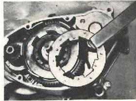
**Gegenhalteschlüssel** ermöglicht das Festhalten der Kupplungsmuffe.
