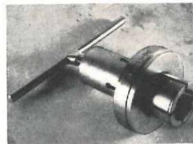
**Lagerabzieher** wird zum Abziehen der Kurbelwellenlager benötigt.
