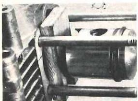
**Kolbenholz** schützt den Kolben nach Demontage des Zylinders vor Beschädigung.
