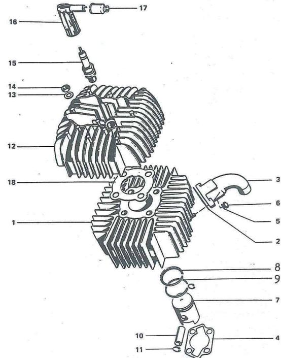
Bei Kolbenbestellung unbedingt Maßgruppe angeben. Gekennzeichnet durch je einen Buchstaben auf dem Kolben und am Zylinder.
